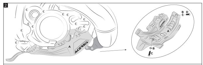
Place the Acerbis skid plate Acerbis (A) on the frame and secure it using two bushings (B), the screw (C) and the screw (D). Posizionare il sottomotore Acerbis (A) sul telaio e fissarlo tramite le due boccole (B), la vite (C) e la vite (D).
